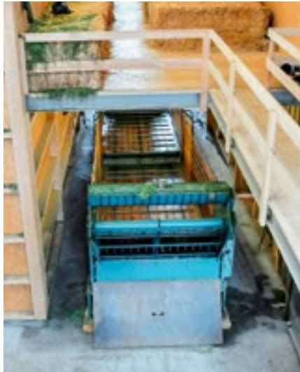
Pour être bien détaché et réparti de façon aérée, le fourrage très humide passe par un doseur.
