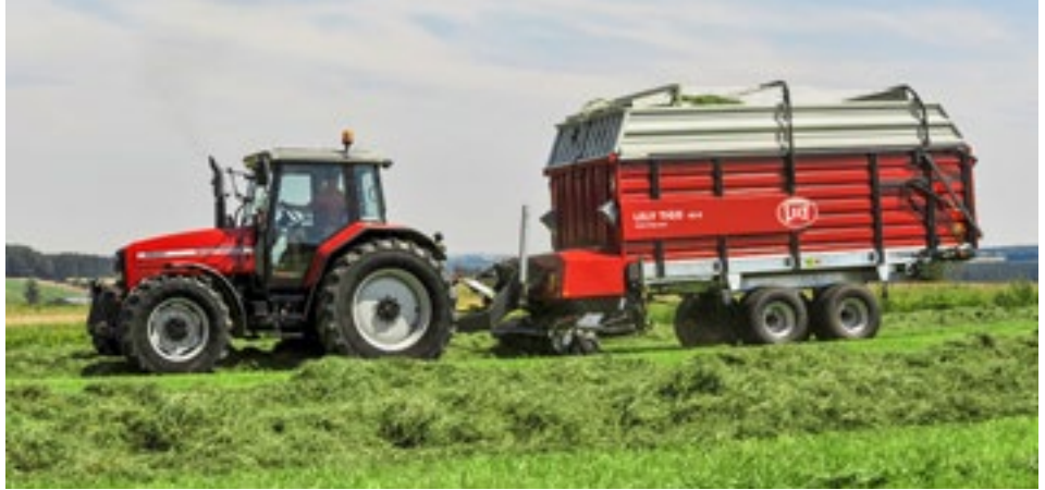
Le fourrage doit rester aéré lorsqu'on le charge pour l'engranger. Pour ce faire, il vaut mieux utiliser une autochargeuse généreusement dimensionnée et faire des andains réguliers.
